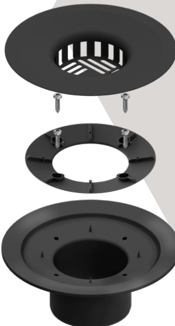
Los sobre embudos se colocan encima y por dentro de los bajo embudos, en forma deslizante, permitiendo regular la altura final de la reja.
